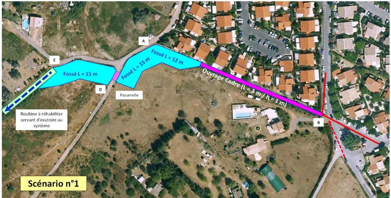
Figure 27 : Bassin versant des Cresses\_ Scénario 1 d'évacuation des eaux pluviales : Aménagements envisagés
