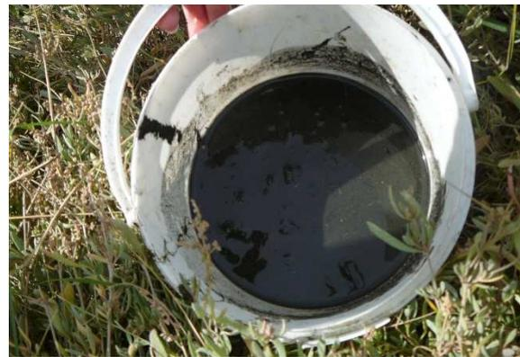
Robine en eau. Prélèvement en bord de rive droite, au niveau d'un élargissement avant les buses passant sous la RD114. Noir, fin, assez peu de sédiment, un peu organique.
