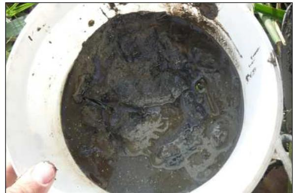
Prélèvement dans les buses qui traversent la RD, en eau à partir du point de prélèvement et vers l'aval. Sédiment très fin et foncé. Granulométrie rapidement plus grossière sous la surface. Prélèvement dans la couche supérieure.
