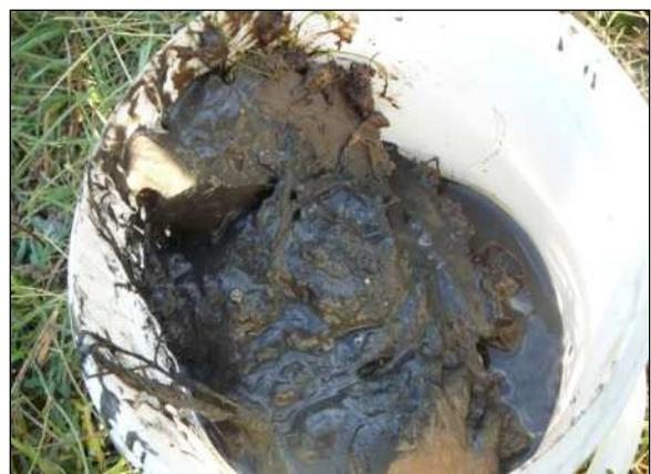
La buse amont (M4 mesure débit) était à sec, et le sédiment trop grossier. On est descendus plus à l'aval, pour trouver une "flaque" avec du sédiment fin, foncé, d'une épaisseur de quelques cm sur un lit de granulométrie plus grossière. Quelques racines et herbes, mais bien enlevées lors du remplissage du flacon.
