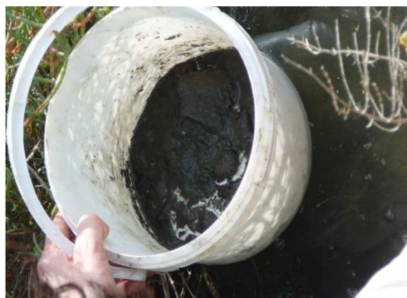
Robine en eau, au niveau de son passage sous la voir ferrée. Prélèvement en bord de rive gauche. Noir, fin, quelques racines, assez liquide.
