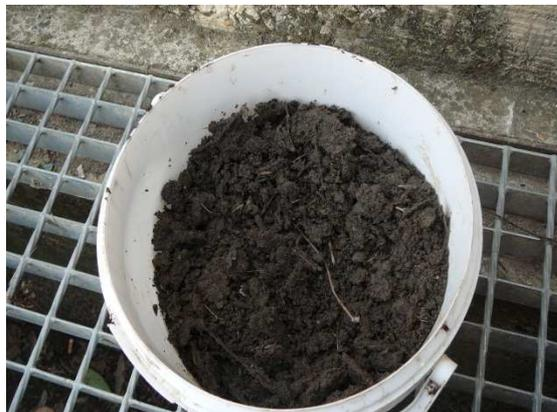
Prélèvement effectué sous la grille, dans 2 buses de béton à sec. Aspect terre mais foncé, et fin, assez organique (feuilles, aiguilles de pin), humide. Le fond du fossé dans lequel débouchent les buses remonte juste derrière les buses, ce qui forme un creux où de l'eau peut stagner.
