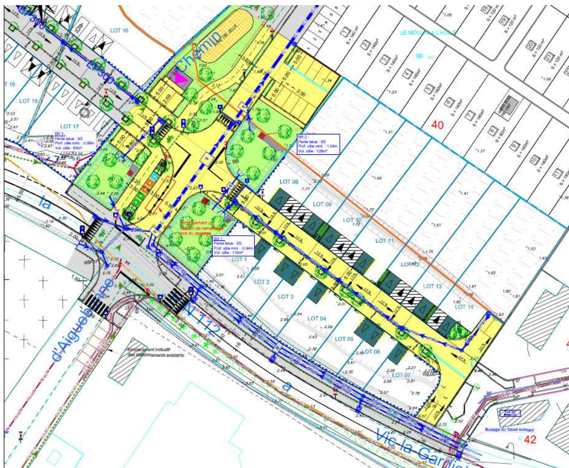
Figure 112 : Extrait du Plan de principe de gestion des eaux pluviales _ Dossier Loi Eau l'Esplanade Est _ SERI_ Mars 2015
